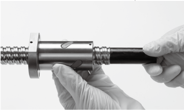
4. 将螺母全行程都转入丝杠上。 注意！确认螺母全部行程都转入丝杠后才能将转换管移开。 Ensure that the ball nut is fully inserted before remove the mandrel.
