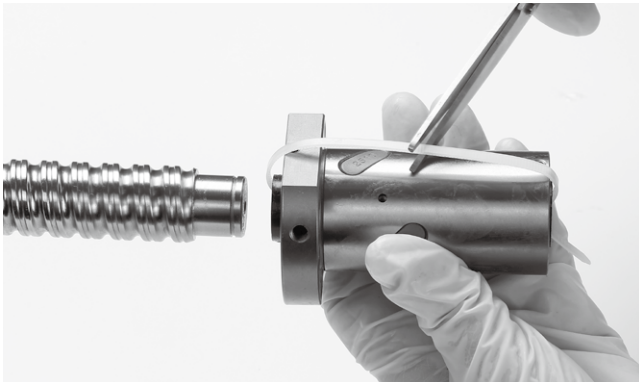
1. 将螺母上的固定线剪开。 Remove the band.
